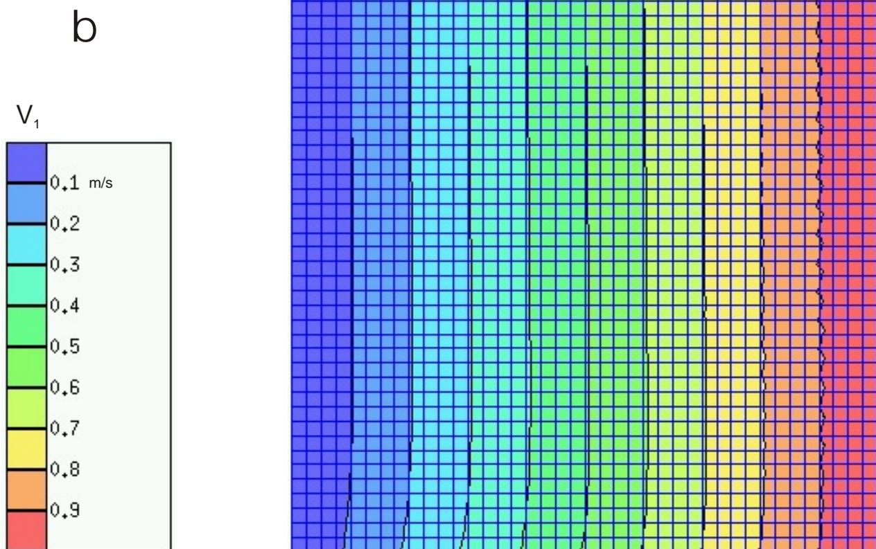
**Bild 21.** Potential-Staupunktströmung, a Vektor- und Wasserstands-Plan, b Berechnungsnetz und  $v_1$  Geschwindigkeitsplan
