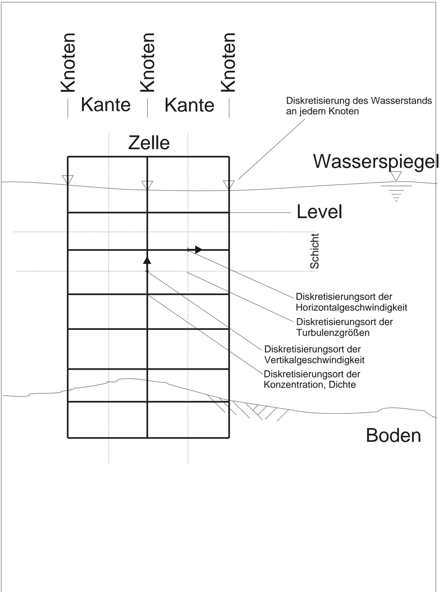
**Bild 15.** Vertikaler Schnitt zur Erläuterung der 3D-Diskretisierung
