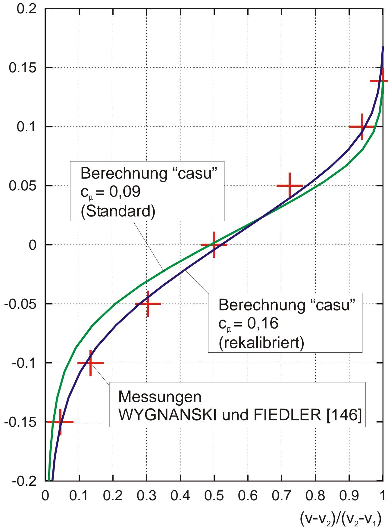
Bild 35. Testfall ebene Scherschicht, Rekalibrierung
